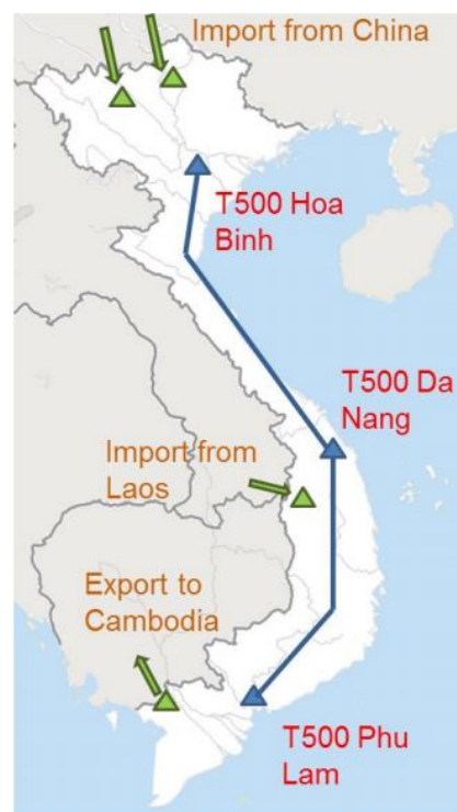
Hình 21. Đường dây 500 kV và trao đổi công suất với các nước lân cận của Việt Nam
