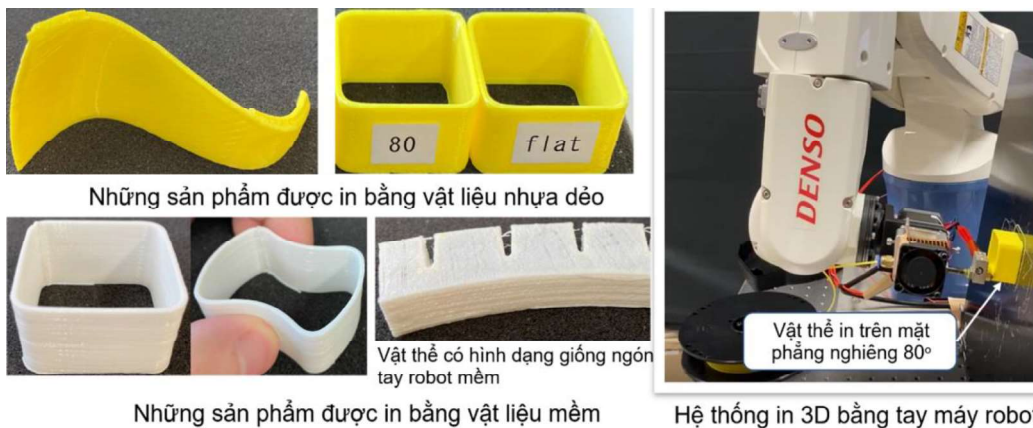
Hình 8. Hệ thống robot in 3D trên một mặt phẳng nghiêng và những mẫu sản phẩm được in bằng vật liệu nhựa dẻo thông thường và vật liệu mềm
