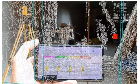
Hình 10. Các kích thước đã đo được tự động xuất ra dưới dạng một bản báo cáo ở một thiết bị khác được kết nối qua Internet (hình ảnh tham khảo từ tài liệu giới thiệu sản phẩm của công ty Informatix Inc.)
