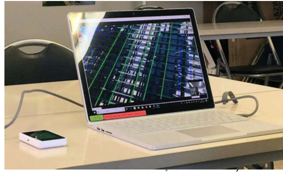
Hình 8. Chia sẻ hình ảnh kiểm tra thực tế tại hiện trường nhìn qua kính HoloLens với một bên không có mặt tại công trường thi công thông qua kết nối Internet (hình ảnh tham khảo từ tài liệu giới thiệu sản phẩm của công ty Informatix Inc.)
