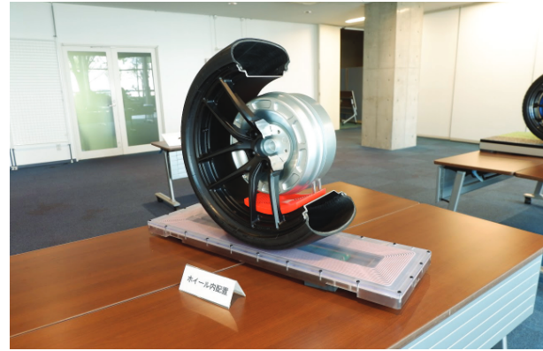
Hình 10. Wireless-in-wheel-motor; thành tựu nghiên cứu xuất sắc nhất trong những năm gần đây của nhóm ô-tô điện.
