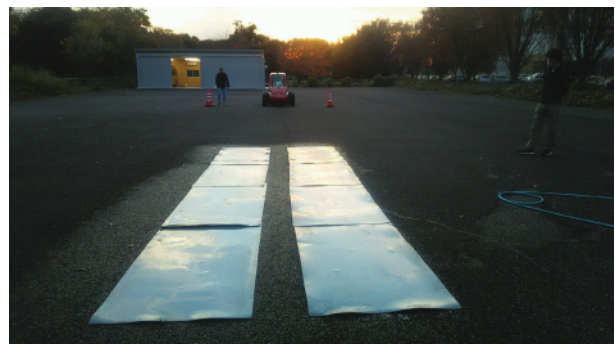
Hình 12. Thí nghiệm chống trượt cho ô-tô điện bằng cách kết hợp điều khiển chuyển động và xử lý ảnh [16].
