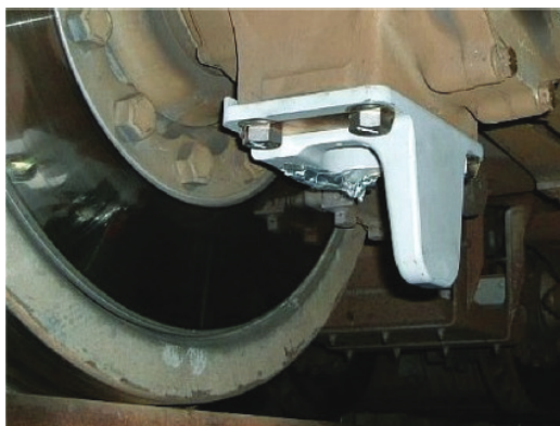
Hình 7. Tấm thép chữ “L” gắn ngoài trục bánh ngấn tàu rời xa đường ray
