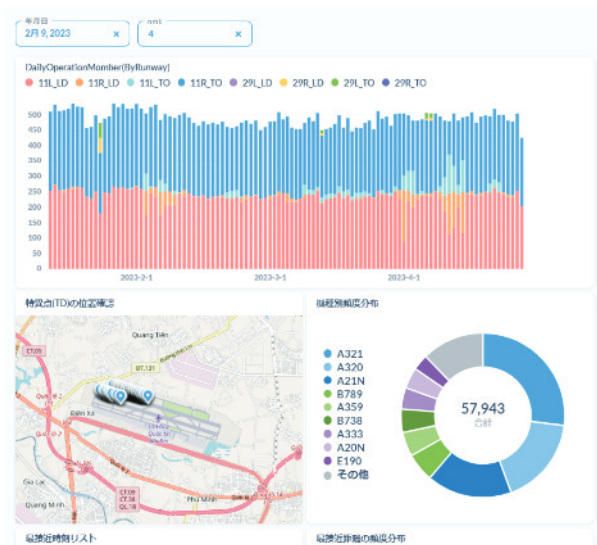
Hình 5: Tỷ lệ sử dụng đường băng của máy bay cất cánh hướng đông dựa trên dữ liệu thu được từ Trạm VOR/DME
